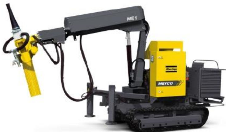
1.7 - сурет – Меусо ME1 робот-манипуляторы
