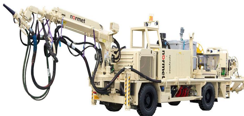
1.5 - сурет – Normet ұсынған Sprauces 5070 VC орташа бүрку қуатына ие роботы
