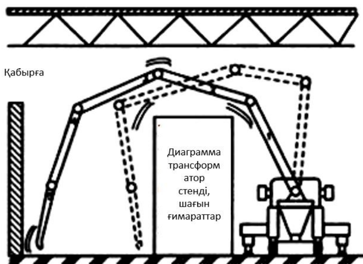
1.9 - сурет – Манипулятордың кедергіні еңсеру схемасы
